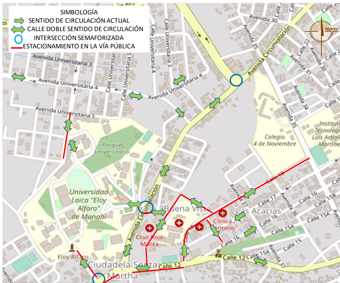
Figura 42. Condiciones de Operación en Situación Actual.
